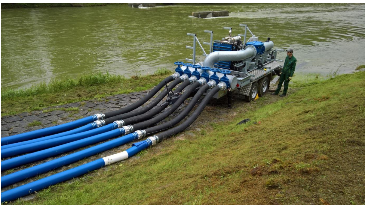
Abbildung 2: Hochwasserpumpe in Betrieb; Blick auf die Ableitungsschläuche Durchmesser je 15 cm
